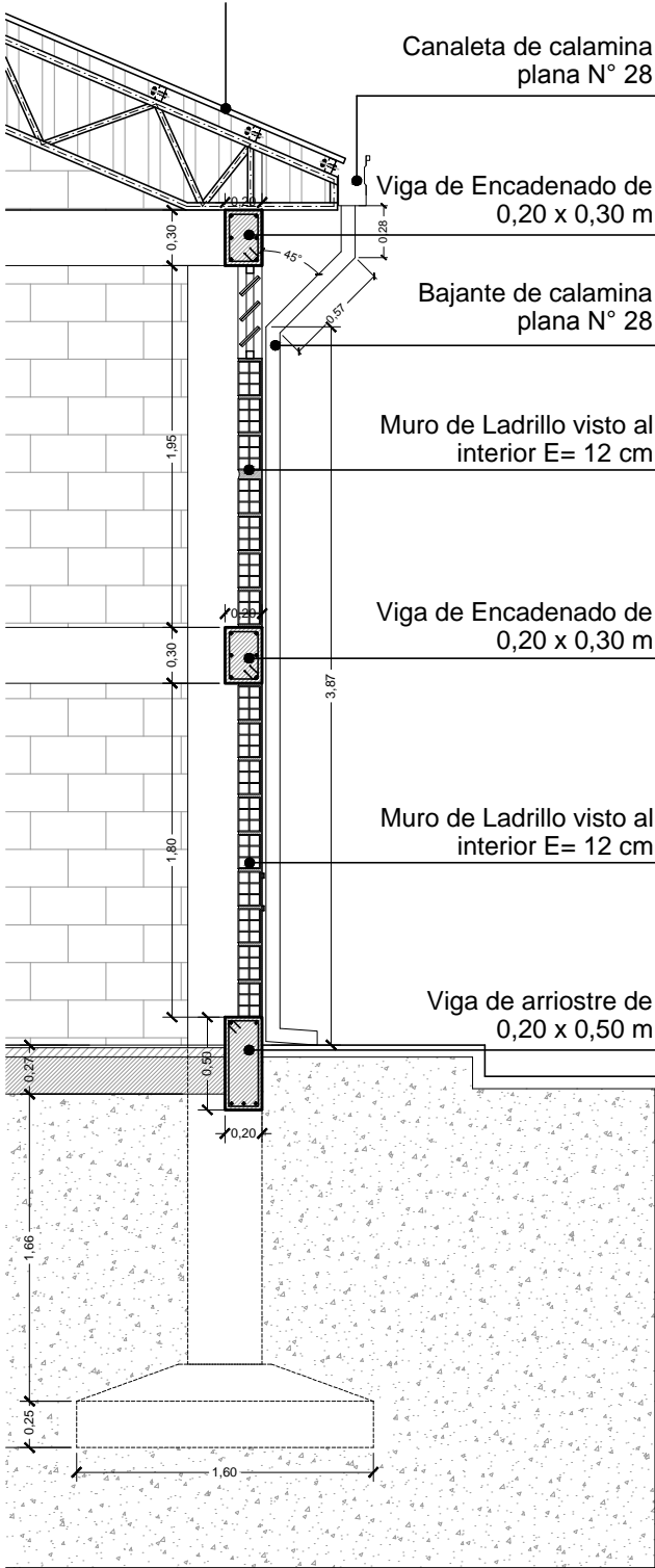
D10- DETALLE CORTE DE BORDE - GALPÓN ESC. 1:20
